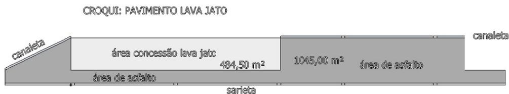
Deverá se assentado 80 m de meio-fio, 136 m de sarjeta, 80 m canaleta, 7 caixas 90x 120x150 cm com grelhas ferro fundido, 210 m<sup>2</sup> de plantio de gramas, conforme croqui em anexo neste Edital.
